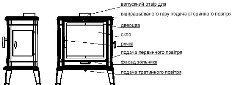
Рис. 1. Схема камінної печі.
